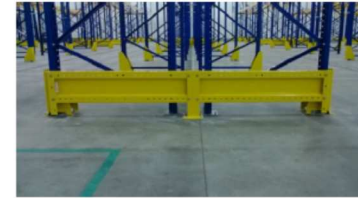
PROTECTION DE RIVE METALLIQUE
